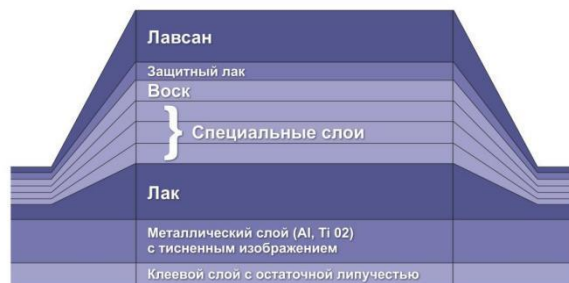
Рис.1. Структура слоёв «Нейтроник 5GRS»
