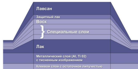
Рис.1. Структура слоёв «Нейтроник МГ-04М»
